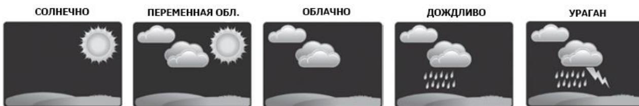
Базовая станция каждые 12 мин измеряет барометрическое давление. Полученные измерения усредняются еже часно и ежедневно и затем сохраняются в памяти станции. В течение трех часов значок давления на экране базовой станции будет меняться исходя из последних 4 средних еже часных показаний.
