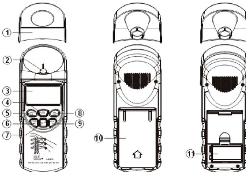
1. Дополнительная насадка – используется в режиме измерения расстояния по горизонтали.
