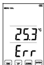
9. Нажатие на кнопку [ESC] возвращает дисплей на шаг назад. Режим калибровки / режим Menu, затем обычный режим. (Если показания нестабильны или электрод не подключен к тестеру, на дисплее появится сигнал "Err" и будет мигать 3 раза, а затем вернется в меню калибровки.)
