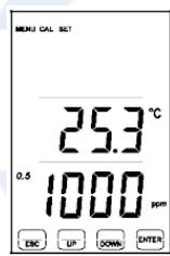
6. После стабилизации показаний нажмите кнопку [UP/DOWN] для корректировки результата измерения до нужного значения калибровки. ВНИМАНИЕ: При нажатии и удержании кнопки изменения будут быстрее.
