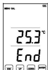
8. Сигнал "End" будет мигать трижды на дисплее, тестер вернется в режим калибровки. Калибровка закончена.
