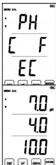
3. Режим CAL отобразит на экране "PH", "C F" и "EC". Выберите "PH" нажатием на кнопку [ENTER] для входа в режим калибровки pH.
