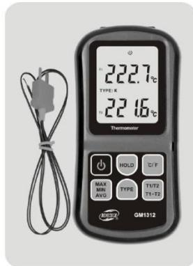
Термопара является одним из наиболее распространенных приспособлений в области температурных измерений, представляющая собой два разнородных металла, объединенных в цепь, в основе ее работы лежит напряжение, изменяющееся благодаря температурной разнице металлов. Если между контактом термопары и ее свободным концом будет присутствовать разница температур, прибор отобразит значение температуры обратное термоэдс, произведенное термопарой.
