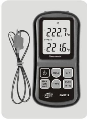
Термопара является одним из наиболее распространенных промышленных приспособлений в области температурных измерений, представляющая собой два разнородных металла, объединенных в цепь, в основе ее работы лежит напряжение, изменяющееся благодаря температурной разнице металлов. Если между контактом термопары и ее свободным концом будет присутствовать разница температур, прибор отобразит значение температуры обратное термоэдс, произведенное
