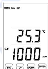
6. После стабилизации показаний нажмите кнопку [UP/DOWN] для корректировки результата измерения до нужного значения калибровки. ВНИМАНИЕ: При нажатии и удержании кнопки изменения будут быстрее.
