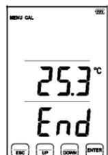
8. Сигнал "End" будет мигать трижды на дисплее, тестер вернется в режим калибровки. Калибровка закончена.
