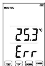
9. Нажатие на кнопку [ESC] возвращает дисплей на шаг назад. Режим калибровки / режим Menu, затем обычный режим. (Если показания нестабильны или электрод не подключен к тестеру, на дисплее появится сигнал "Err" и будет мигать 3 раза, а затем вернется в меню калибровки.)
