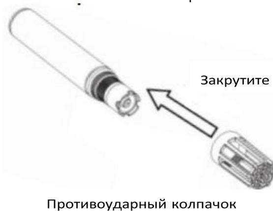
Все датчики оснащены противоударными колпачками, обеспечивающими защиту при измерении. Снимайте защитный колпачок в следующих случаях:
