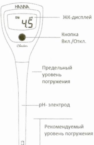
Перед первым включением нужно подготовить электрод к работе. При поставке электрод сухой, его следует вымочить в растворе для хранения или в буфере 7,01. Погрузить кончик электрода, примерно, на 4 см. Выдержать несколько часов (можно оставить на ночь). Возможно, на электроде выступил налет соли. Налет следует смыть теплой водой.
