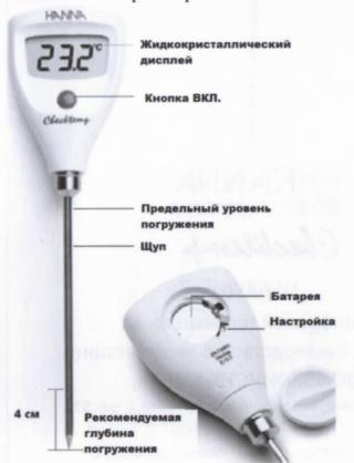
Для включения Checktemp® нажмите клавишу ON/OFF. После включения все символы ЖК дисплея отобразятся в течение 1 с и автоматически запустится процедура контроля калибровки CalCheck®. Появление на экране надписей "CAL" и "0" означает, что характеристики Checktemp® находятся в пределах допуска и прибор готов к работе.
