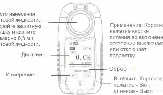
Перед началом измерений проверьте, сбрасывались ли показания прибора, используя чистую воду. Если на дисплее не отображается ноль, сбросьте показания прибора.
